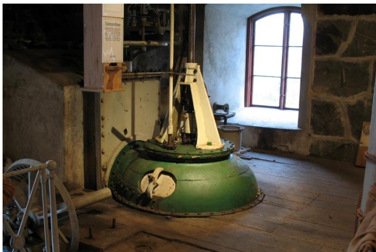
Vattenturbinen i kvarnen, tillverkad i USA på 1870-talet.
